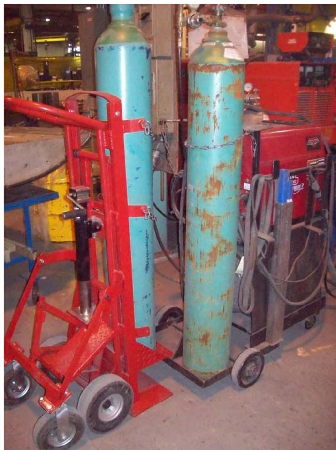
*Positionnement du diable à proximité du palier de la soudeuse : le vérin mécanique permet de soulever la bonbonne à 15 cm du sol soit au même niveau que le palier de la soudeuse.*
