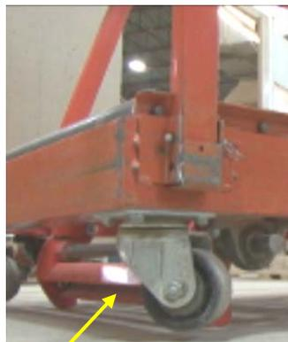
Levier en position B pour bloquer les roues de la plateforme.
