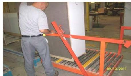
Le travailleur glisse le meuble sur la plateforme de transfert, placée dans le prolongement du convoyeur de l'assemblage. Le levier est abaissé pour stabiliser la plateforme.
