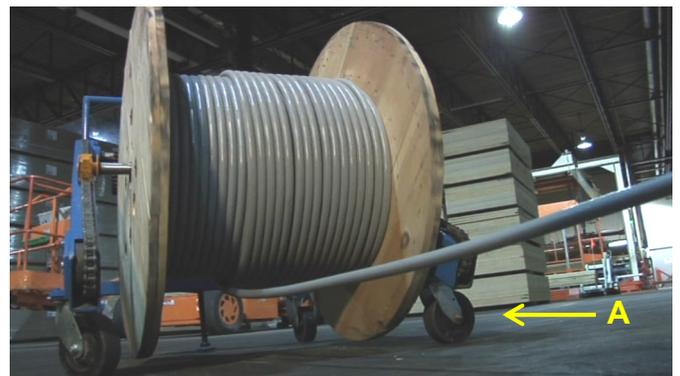
*Stabilité du chariot élévateur de la bobine de câble électrique. Roues multidirectionnelles l'avant (A) et unidirectionnelle à l'arrière.*
